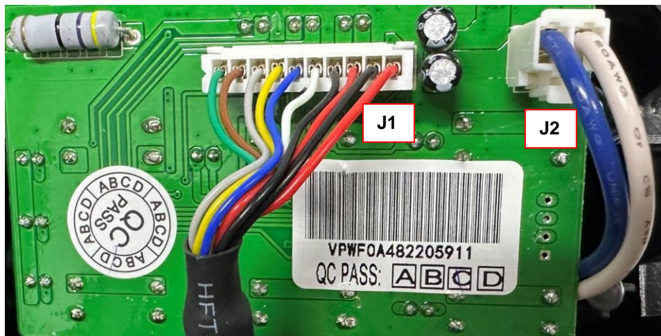
Figura 1. Conectores en el tablero de instrumentos (EB1)
