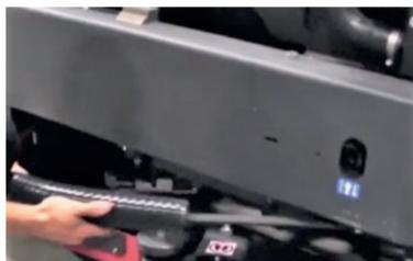
1. Lorsque le nettoyage est terminé, videz le réservoir de récupération. Commencez par retirer le tuyau de vidange du réservoir de récupération de son dispositif de rangement.
