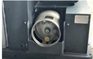
3. Vérifiez la jauge de carburant sur le réservoir GPL. Utilisez uniquement le type de carburant prévu pour cette machine (comme indiqué sur l'autocollant du réservoir de carburant).
