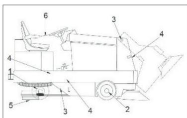
2. Graissez tous les points de graissage de la machine (voir p. A-28 du manuel « Mode d'emploi »).
