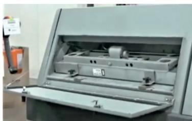
12. Nettoyez et inspectez le filtre du panneau de contrôle de la poussière. Nettoyez le filtre après chaque utilisation. Vérifier si le filtre est usé ou endommagé. Remplacez le filtre s'il est déchiré ou perforé.
