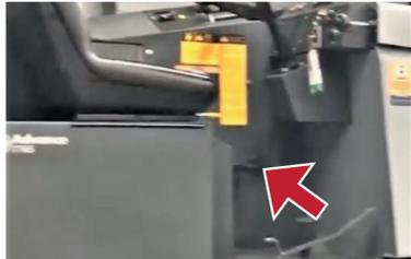
2. Relâchez le frein de stationnement. Réglez le siège dans une position confortable.
