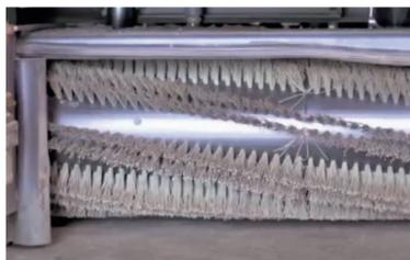
11. Inspectez la brosse de balayage principale. Assurez-vous que la brosse est correctement installée et exempte de débris ou de corps étrangers. Remplacez la brosse principale si les poils mesurent moins de 1 po de longueur.
