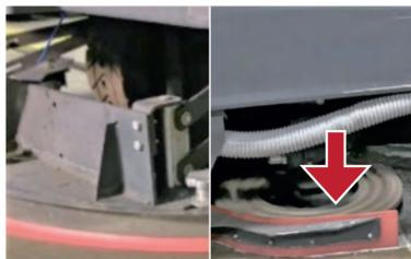
7. Vérifiez si les lames de la raclette sont usées ou endommagées. Faites pivoter ou remplacez les lames de la raclette au besoin.
