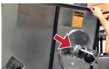
10. Assurez-vous de bien rincer le système de fermeture du flotteur avec un tuyau d'arrosage et de l'eau claire. Laissez le couvercle du réservoir de récupération ouvert lorsque vous avez terminé de nettoyer le réservoir de récupération.
