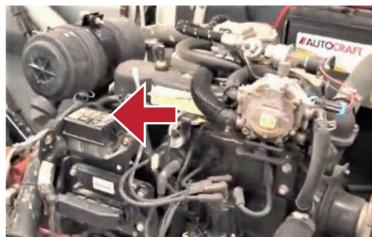
8. Vérifiez les niveaux d'huile moteur et de fluide hydraulique.
