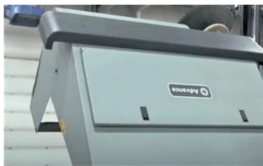
7. Videz régulièrement le bac collecteur de débris pendant et après les opérations de balayage. Assurez-vous que la porte de la trémie est fermée avant de soulever la trémie. Ne remplissez pas la trémie au-delà de sa capacité.
