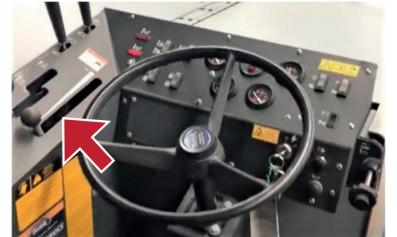
4. Engagez le levier de commande de levage de la brosse principale d'un cran.
