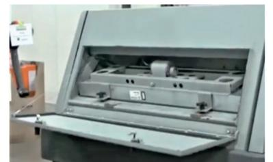
14. Vérifiez le compartiment de contrôle de la poussière. Retirez le filtre du panneau et nettoyez-le au besoin. Réinstallez le filtre du panneau dans le compartiment de contrôle de la poussière.
