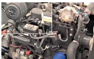
1. Changez l'huile moteur et le filtre à huile. Remplacez le filtre à air du moteur. Remplacez le filtre à carburant et le filtre à huile hydraulique.
