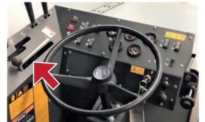
4. Poussez le levier de la vanne d'arrêt de la solution vers l'avant jusqu'au débit de solution souhaité. Positionnez le commutateur en mode « lapin » pour régler le moteur à plein régime.
