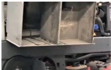
5. Basculez le réservoir de récupération en position « ouvert ». Utilisez un tuyau d'arrosage et de l'eau claire pour bien rincer le réservoir de récupération.
