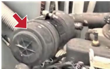
5. Vérifiez le filtre à air et l'indicateur de filtre à air. Remplacez le filtre s'il est sale.
