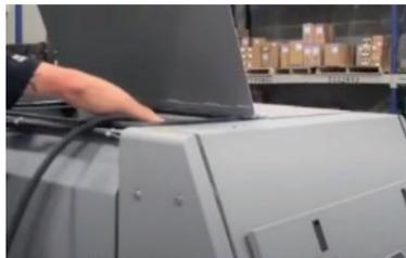
6. Remplissez le réservoir de solution jusqu'à la ligne de remplissage à l'intérieur du réservoir de solution. Ajoutez toujours le détergent après le remplissage.
