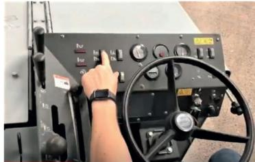
3. Activez les interrupteurs d'aspiration de la brosse principale, de la brosse latérale et du contrôle de la poussière. Positionnez le commutateur en mode « lapin » pour régler le moteur à plein régime.
