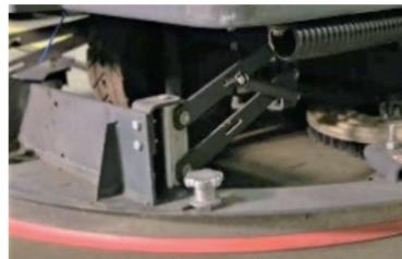
8. Vérifiez que l'ensemble de la raclette principal est correctement positionné (voir page A-34 dans le manuel « Mode d'emploi » du modèle 7765). Vérifiez si la lame de la raclette est usée ou endommagée.
