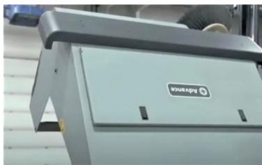
10. Relevez la trémie principale. Assurez-vous que la trémie est vide et propre. Assurez-vous d'engager la barre de sécurité de la trémie immédiatement après l'ouverture de la trémie. Désengagez la barre de sécurité de la trémie avant de fermer la trémie.
