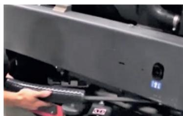
7. Lorsque le nettoyage est terminé, videz le réservoir de récupération. Commencez par retirer le tuyau de vidange du réservoir de récupération de son dispositif de rangement.
