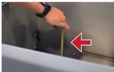
2. Ensuite, desserrez le bouchon de vidange en tournant l'axe du bouchon de vidange dans le sens inverse des aiguilles d'une montre. Une fois desserré, retirez le bouchon de vidange du trou de vidange du réservoir de récupération.
