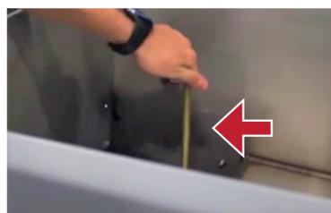
8. Ensuite, desserrez le bouchon de vidange en tournant l'axe du bouchon de vidange dans le sens inverse des aiguilles d'une montre. Une fois desserré, retirez le bouchon de vidange du trou de vidange du réservoir de récupération.
